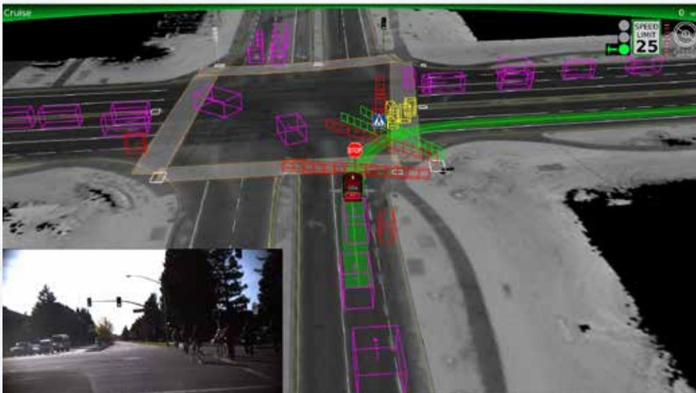
Ontologia que identifica uma série de objetos diferentes ao redor de um veículo parado no semáforo. No canto inferior esquerdo: foto da cena conforme vista do interior do veículo (JAFÉ, 2014).
